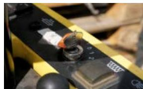
Posizionare la chiave su ACC per strumentazione con motore a combustione interna.
